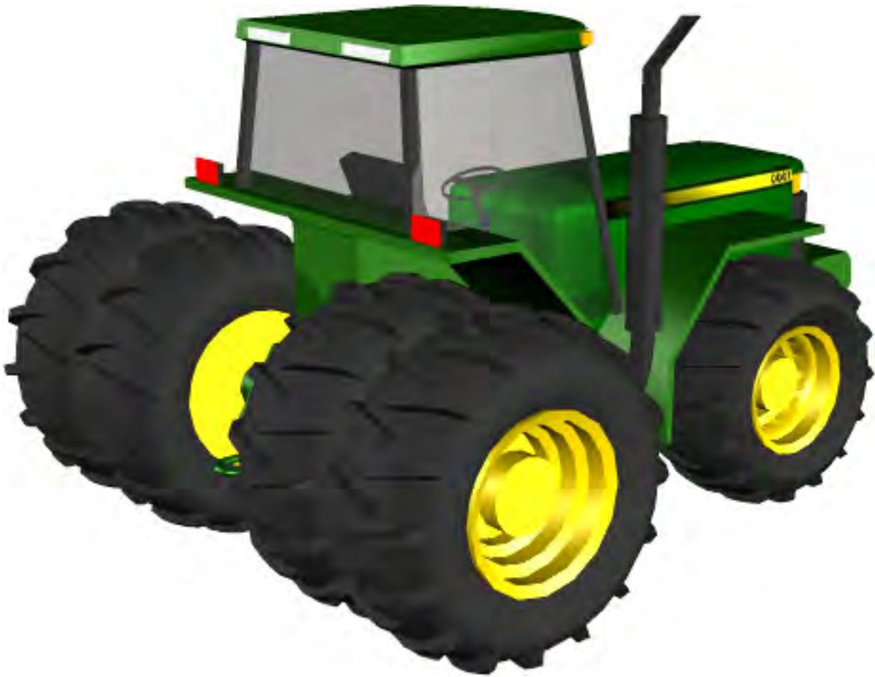
siempre que sea posible deben utilizarse tractores especiales que ofrezcan mayor estabilidad, tales como los de doble tracción y los de cadenas, al tiempo que se limite el uso de tractores de ruedas estrechos (vía mínima del eje de ruedas motrices inferior a 1.125 mm) o de tractores elevados o zancudos (altura libre máxima superior a 1.000 mm). Igualmente se usarán tractores con anchura de vía y longitud entre ejes máximas
