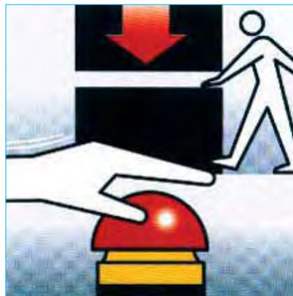
Estos elementos de protección, deben contar además con una serie de disposiciones adicionales que paralicen, desconecten o pongan en situación de seguridad la máquina protegida, en caso de acceso voluntario o involuntario a la zona peligrosa, mediante dispositivos automáticos.
