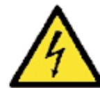
Es el originado por las máquinas que pueden dar lugar quemaduras o electrocuciones. Estos peligros, pueden ser por contactos eléctricos directos al entrar el cuerpo en contacto con una parte activa (enchufes, cables pelados, etc..), o pueden ser indirectos, al entrar en contacto el cuerpo con alguna parte de la máquina donde pueda haber por ejemplo una derivación de la corriente por mal aislamiento.
