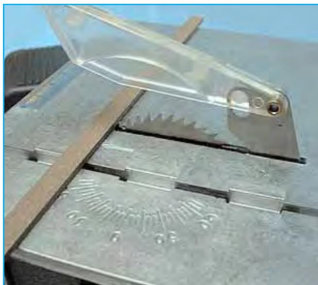
La postura normal del trabajador es frontal a la herramienta, junto a la mesa, y empujando con ambas manos la pieza. Puesto que rara vez la máquina está dotada de guías u otros complementos, el corte se efectúa a pulso. Esta máquina destaca por su sencillez de manejo y precisión de trabajo relativo, lo que facilita su uso por personas no cualificadas que toman confianza hasta el extremo de despreciar su peligrosidad.
